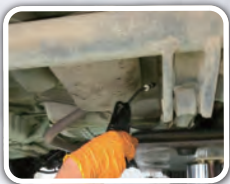
汚れをエアブロー
